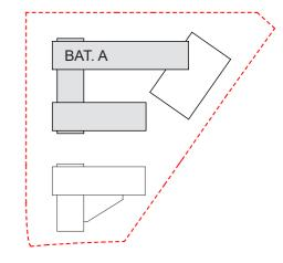
charge utile 15.0 kN/m<sup>2</sup> charge permanente 2.0 kN/m<sup>2</sup>
